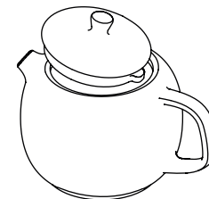
Tapa con pasador antivuelco. Lid with anti-tilt lug.
